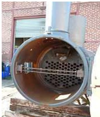
En 1827, **Marc Seguin**, met au point la « chaudière tubulaire » permettant de multiplier par 6 la puissance développée. Cette invention d'abord appliquée aux bateaux circulant sur le Rhône, est ensuite développée sur la **locomotive Seguin**. La 1<sup>ère</sup> ligne de chemin de fer française est mise en service
